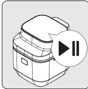
Remplacez la cuve de cuisson (6) dans le corps et refermez le couvercle. Pour poursuivre le processus de cuisson, appuyez sur l'icône de démarrage/pause du panneau de commande numérique.
