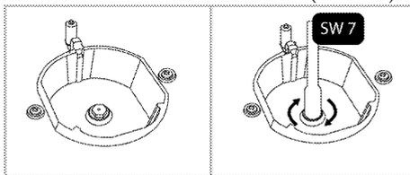
5. Si votre produit est équipé d'une chambre de combustion pour wok avec un injecteur à entrée latérale, retirez l'injecteur avec une clé numéro 7.
