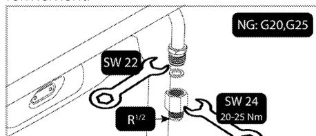
3. Enroulez un produit d'étanchéité autour de la partie filetée de l'interconnecteur. Raccordez la partie filetée du tuyau/tuyau de gaz de sécurité à l'interconnecteur à l'aide de la clé de 24 mm et serrez fermement, en maintenant l'interconnecteur en place avec la clé de 24 mm.
