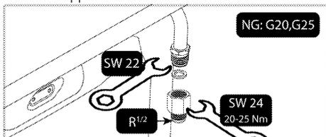
3. Обмотайте герметичний матеріал навколо різьбової частини з'єднувача. Під'єднайте різьбову частину захищеного газового шланга/труби до з'єднувача за допомогою гайкового ключа на 24 мм, а потім надійно затягніть її, утримуючи з'єднувач на
