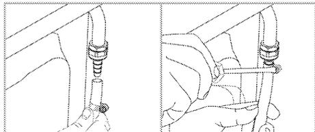
5. Vous devez vérifier l'étanchéité de la pièce de raccordement après le raccordement.
