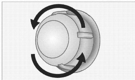
3. Si la lampe de votre four est de type (A) comme l'indique le schéma ci-après, ôtez-la en la faisant pivoter comme illustré, avant de la remplacer. Si, par contre, elle est de type (B), tirez-la pour l'ôter comme illustré sur le schéma avant de la remplacer.
