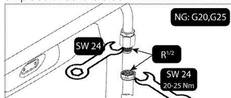
4. Vous devez vérifier l'étanchéité de la pièce de raccordement après le raccordement.
