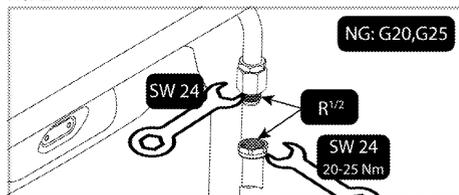
4. Після підключення необхідно перевірити з'єднувальну деталь на предмет витoku.
