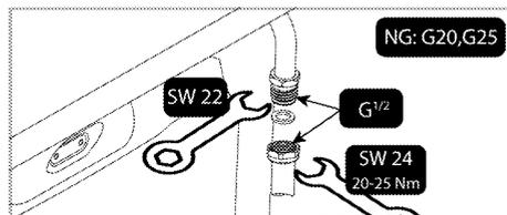
3. Vous devez vérifier l'étanchéité de la pièce de raccordement après le raccordement.
