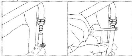
5. Після підключення необхідно перевірити з'єднувальну деталь на предмет витоку.
