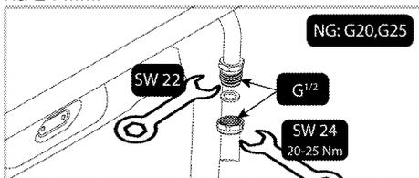
3. Після підключення необхідно перевірити з'єднувальну деталь на предмет витoku.
