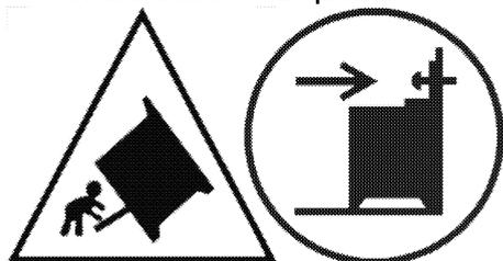
**Avertissement :** Ce système de stabilisation doit être installé pour empêcher l'appareil de basculer. Consultez les instructions pour l'installation.
